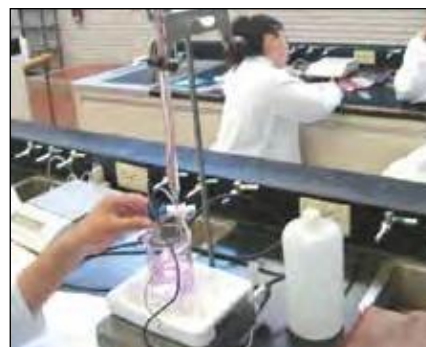
Fig. 3.10 En una titulación, para el virre o cambio de color se puede utilizar fenolftaleína.
