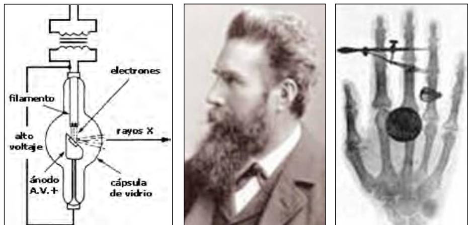
Fig. 2.7 Diagrama del tubo de rayos X utilizado por Röntgen y la primera imagen de las manos de su esposa.
