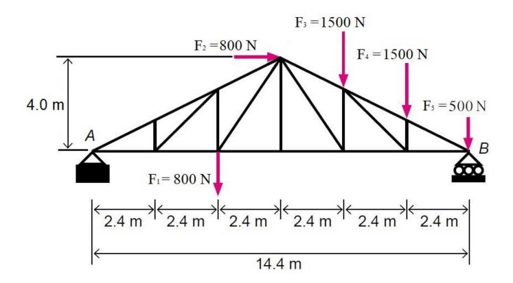
23. Calcula la magnitud de las reacciones en los apoyos de la siguiente viga. Considera despreciable el peso de la viga, que R1 corresponde a la reacción del rodillo, que R2 corresponde a la reacción horizontal de la articulación y que R3 corresponde a la reacción vertical de la articulación.
